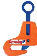
La pinza per travi IPBSNZ serve per il sollevamento, il trasferimento e l'impilatura. L'occhio di sollevamento disassato consente il sollevamento piano di travi I, il sollevamento di elementi di fabbricazione e sezioni di navi. Questa serie di pinze può essere utilizzata nel movimento orizzontale e verticale, nel trasferimento e nell'impilatura di strutture dal design più svariato quali travi a I a seconda dell'applicazione desiderata.
