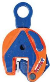
La pinza di sollevamento a presa verticale IP10 è impiegata nelle operazioni di sollevamento, rotazione, movimento o trasferimento verticale di lamiere, lastre o altri elementi di strutture da orizzontale a verticale e nuovamente a orizzontale (180°) in base alle esigenze. Viene impiegata come presa semplice o quando si usa un bilancino di sollevamento con più linee verticali di rilascio.
