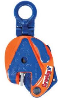
La pinza per travi IPVZ / IPVUZ viene utilizzata per il sollevamento verticale e il trasferimento di profilati a L e altri carichi che presentano solo una piccola area di presa per la pinza (il modello "U" presenta un occhio di sollevamento universale).
