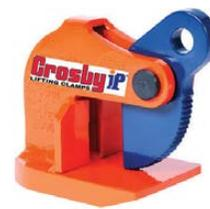
La pinza di sollevamento a presa orizzontale IPOHOZ è utilizzata per il sollevamento e trasferimento, in posizione orizzontale, di lamiere sottili e altri materiali che se alzati fletterebero o si piegherebbero. È necessario utilizzare due o più pinze.
