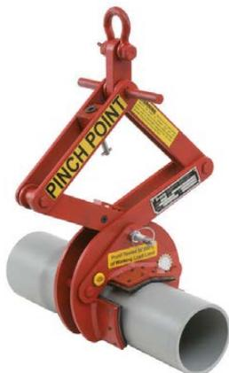
La nuova pinza per tubi Crosby serie Clamp-Co è un ottimo sistema per manovrare oggetti cilindrici. Dotata pad realizzati in materiale speciale anti scivolo, questa nuova pinza offre un metodo eccellente per manovrare qualsiasi tipo di tubo o barra solida, da 88,9 mm a 914 mm, soprattutto quando è imprescindibile non danneggiare la superficie del materiale.
