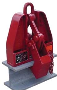
Le pinze Clamp-Co per travi di Crosby offrono un metodo efficiente per la movimentazione di travi flangiate e per travi composte. Al momento di sollevare, queste pinze afferrano la trave in tre punti e quando è adeguatamente bilanciata e guidata la trave può essere movimentata perfino quando la pinza è leggermente decentrata sulla lunghezza.
