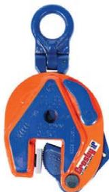
La pinza di sollevamento a presa verticale IPU10 è impiegata nelle operazioni di sollevamento, rotazione, movimento o trasferimento verticale di lamiere, lastre o altri elementi di strutture da orizzontale a verticale e nuovamente a orizzontale (180°) in base alle esigenze. L'occhio di sollevamento a cerniera permette alla pinza di posizionare e sollevare il carico da qualsiasi direzione e grazie a una braca a più bracci evita di caricare lateralmente la pinza.
