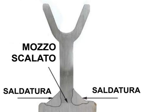
Una saldatura con penetrazione completa è uno standard nelle pulegge da 1016 mm e di dimensioni maggiori.
