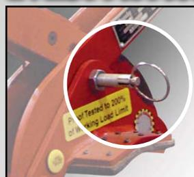
Facilità di bloccaggio e di sbloccaggio della leva di trasporto.
