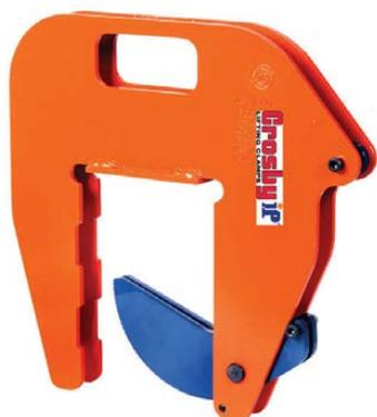
L'IPCC è adatto per il sollevamento verticale e il trasferimento di sezioni di tubo in cemento e pozzi. Applicazione e rimozione della pinza molto semplici grazie agli attacchi di trasporto incorporati. Solitamente utilizzato in combinazione con una catena da 7 mm (non in dotazione). È necessario utilizzare due o più pinze.
