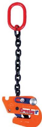
Le pinze per travi IPSTARTEC11 sono state concepite specificamente per il sollevamento con il corpo in posizione verticale, l'inclinazione controllata, il trasporto e l'impilamento di profilati in acciaio ad "H" e a "I". Collocando la guida a catena nella posizione corretta, è semplice passare dal sollevamento all'inclinazione e viceversa, spostando il centro di gravità.
