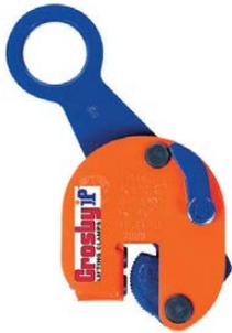
La pinza per travi IPBKZ serve per il sollevamento, il trasferimento e l'impilatura di travi H. Un occhio di sollevamento di controbilanciamento consente alla flangia della trave di rimanere verticale. Questa serie di pinze può essere utilizzata nel movimento orizzontale e verticale, nel trasferimento e nell'impilatura di strutture dal design più svariato quali travi H, angoli, ecc., a seconda dell'applicazione desiderata.
