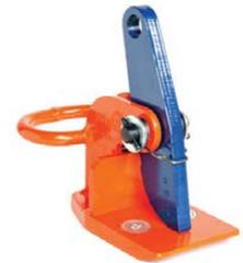
Le pinze di sollevamento a presa orizzontale IPH10 sono dotate di un pretensionatore caricato a molla realizzato in materiale speciale anti-danneggiamento che consente all'operatore di fissare la pinza al materiale per il trasferimento o il sollevamento in orizzontale. È necessario utilizzare due o più pinze.
