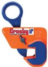
La pinza per travi IPBHZ serve per il sollevamento e il trasferimento orizzontale di travi in acciaio. La base è intagliata per consentire l'utilizzo delle pinze ai capi delle travi oltre che a livello della flangia. Questa serie di pinze può essere utilizzata nel movimento orizzontale e verticale, nel trasferimento e nell'impilatura di strutture dal design più svariato quali travi a I, travi a H, angolari, ecc., a seconda dell'applicazione desiderata.
