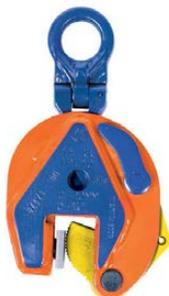
L'IPU10/A scatta automaticamente sul materiale non appena la pinza viene collocata sulla lastra. Il fatto che il blocco di sicurezza rimanga in posizione mentre la pinza si chiude impedisce il verificarsi di situazioni pericolose. La chiusura della pinza IPU10/A in punti difficili da raggiungere non rappresenta un problema.
