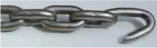
Nonostante la resistenza alla rottura ICE molto più alta = 1200 N/mm<sup>2</sup> in rapporto al grado 80 = 800 N/mm<sup>2</sup> l'allungamento a rottura è identico!
