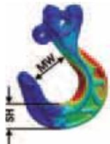
La progettazione con elementi finiti ha permesso di realizzare ganci più leggeri del 25 % in rapporto a ganci grado 80 del diametro maggiore, pur mantenendo la stessa apertura e altezza della base.
