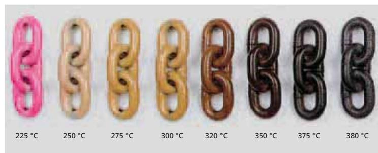
La verniciatura speciale a polvere epossidica fluorescente VIP, indica in modo durevole la temperatura massima alla quale è stata esposta la catena VIP.
