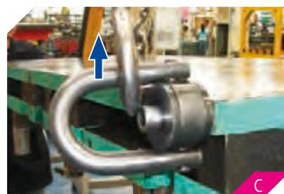
I punti di sollevamento con il design mostrato sopra non si possono posizionare automaticamente nella direzione di tiro. **Foto reali di usi scorretti e pericolosi: il carico deve essere sollevato con quattro punti di sollevamento e due gru.**
