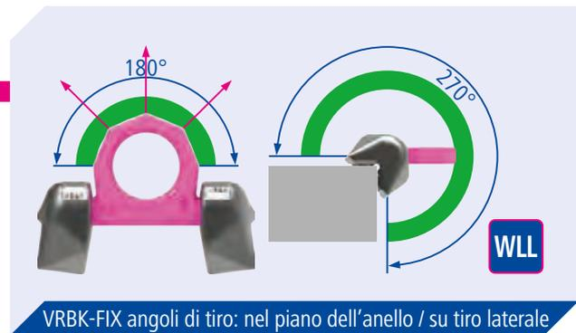
VRBS-FIX e VRBK-FIX possono essere utilizzati con differenti angoli di carico. Si prega di fare riferimento alla tabella di Carico Massimo di Lavoro a p.84.
